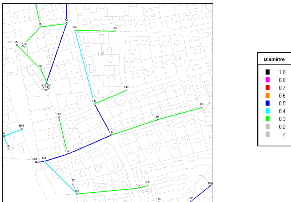
Figure 44 : Remplacement des réseaux rue des Ormeaux
